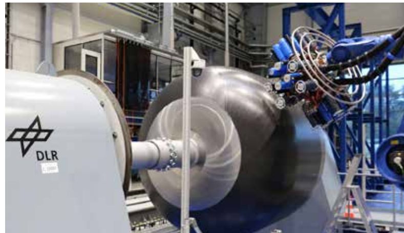
Demonstratorfertigung eines Wasserstoffspeichers mit STAXX Flex AFP-System
